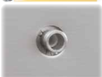
Schauloch in der Ofentür (Durchmesser 20 mm)
