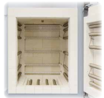
Fünfseitige Beheizung und spezielle Anordnung der Heizelemente für eine optimale Temperaturverteilung
