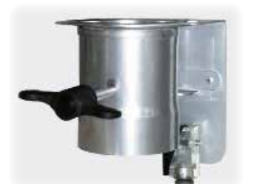
Halbautomatische Zuluftklappe für die Resttrocknung bei Kammeröfen bis 300 Liter. Die Klappe schließt automatisch bei einer voreingestellten Temperatur. Ein manuelles Schließen der Zuluft nach der Trockenphase entfällt.
