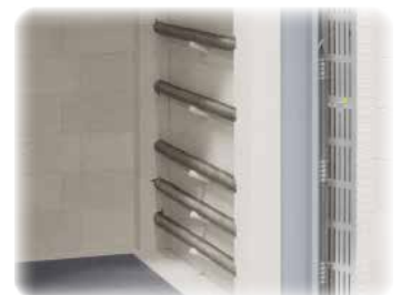
Dreiseitige Beheizung durch Heizelemente auf Tragerohren (N 500 E)
