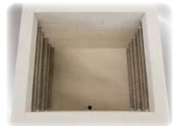
Heizelemente auf Tragrohren sorgen für eine freie Wärmeabstrahlung
